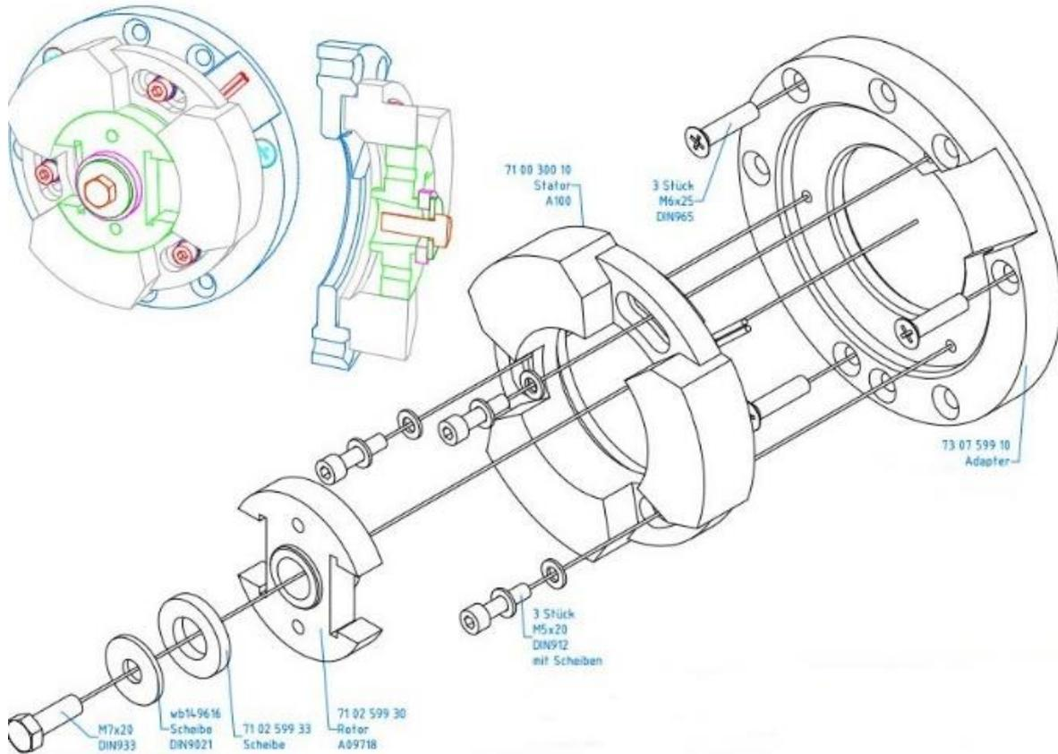
Setzen Sie die neue Adapterplatte inkl. Stator so auf das Kurbelgehäuse, dass die Kabelöffnung der Platte auf etwa 2 Uhr, also in Richtung des Kabelausganges zeigt.
