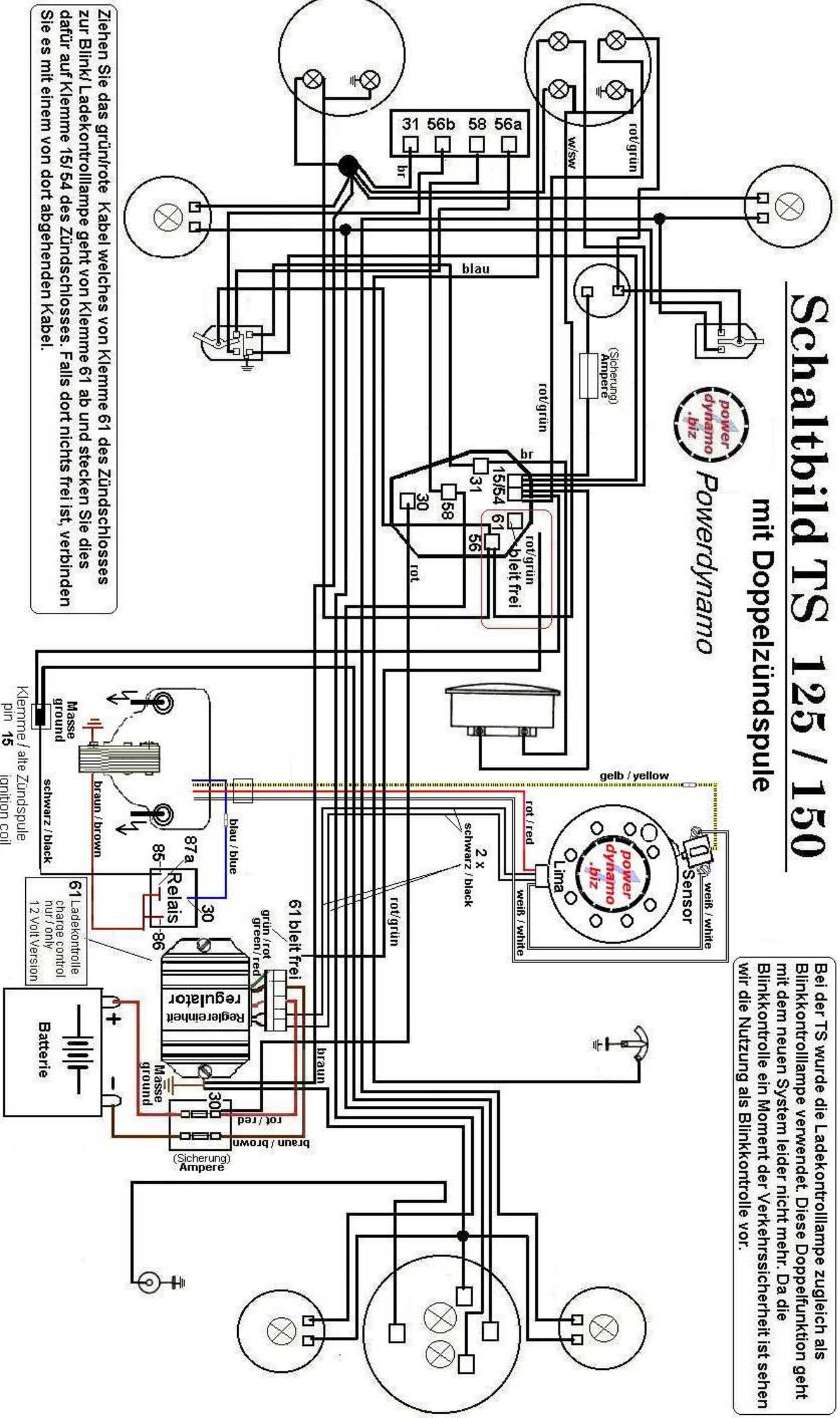
Ziehen Sie das grünlote Kabel welches von Klemme 61 des Zündschlosses zur Blink/ Ladekontrolllampe geht von Klemme 61 ab und stecken Sie dies dafür auf Klemme 15/ 54 des Zündschlosses. Falls dort nichts frei ist, verbinden Sie es mit einem von dort abgehenden Kabel.
