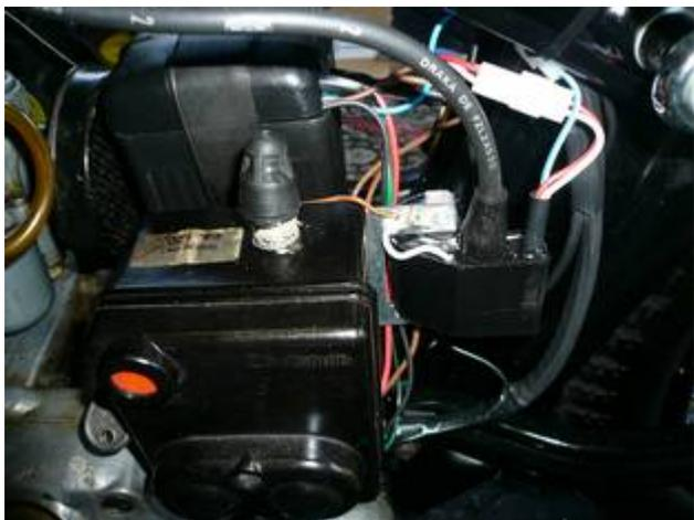
Die Zündspule haben wir neben den Schaltkasten gesetzt da unser Zündkabel ja eh schon vom Schaltkasten zur Zündkerze nicht all zu lang war. Der Zündkasten ist auf seiner Rückseite mit 2 Senkschrauben befestigt und eine davon hat genau den richtigen Abstand und Höhe um die neue Zündspule perfekt zu befestigen.
