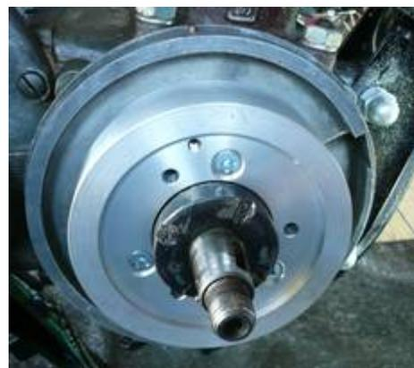
Als nächstes kam dann die neue Adapterplatte die die Grundplatte mit der neuen Lichtmaschine verbindet. Auf ihr befindet sich dann auch schon die erste (Rot) Markierung die später zur Zündeneinstellung benötigt wird.
