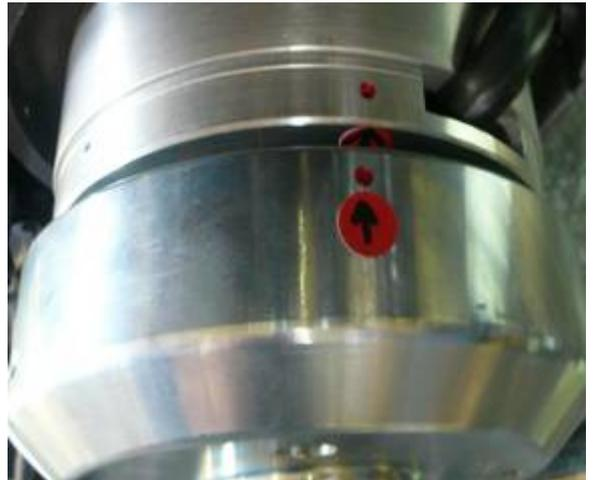
Auch hier sei gesagt das wir einen Zylinderkopf haben, wo die Kerze nach Rechts (in Fahrtrichtung) zeigt! Und nicht wie bei einigen Modellen nach oben. Aber das gab uns die Möglichkeit bei heraus geschraubter Zündkerze mit einer kleinen Taschenlampe ins Innere des Zylinders zu schauen. Man konnte ganz gut sehen wann der Kolben im OT stand. Sicherlich ist das hier nur Augenmaß aber was anderes war halt nicht zur Verfügung.
