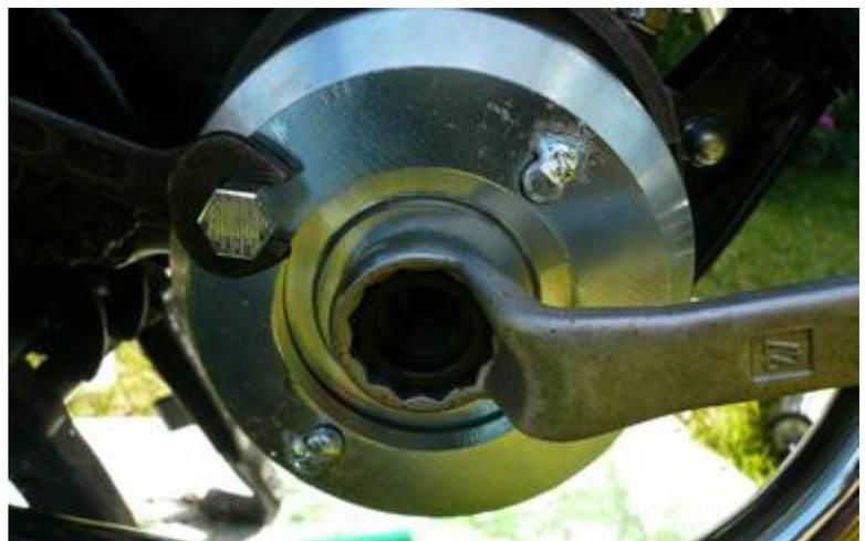
Der Gegenhalter ist eine sinnvolle Investition, er ermöglicht ein angenehmes und sicheres festziehen der Schwungmasse. Für meine Empfindung sind aber die Haltenasen ein klein wenig zu kurz und die Gegenhalteschlüsselgröße könnte man von 13 auf 17 vergrößern um einen längeren Schlüssel nehmen zu können für etwas mehr Gegenmoment!
