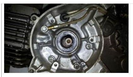
Penibel alle Verunreinigungen entfernen Die würden die neue Anlage schädigen. Bei mir fehlte auch die Dichtung vom Deckel.
