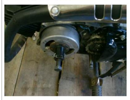
Danach die 3 Schrauben der Grundplatte entfernen. Ebenso das Kabel vom Leerlaufkontrollschalter.
