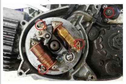
So schaut der Motorblock dann ohne Lichtmaschine aus.
