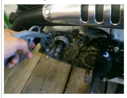
Die Passfeder auf der Kurbelwelle entfernen. Wird beim neuen System nicht mehr benötigt. Der neue Rotor klemmt nur über den Konus.
