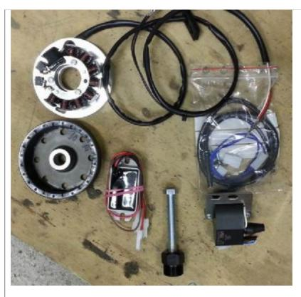
Die neue Anlage mit den mitgelieferten Schrauben wie im Bild montieren. Dabei daruaf achten, das die Grundplatte plan auf dem Motorblock aufliegt.
