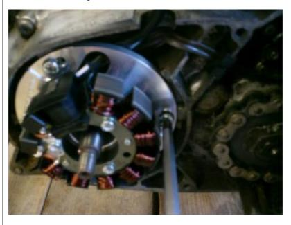
Auf dem neuen Rotor ist nur eine Markierung drauf. Dies ist die Markierung des Zündzeitpunkts. Auf der Grundplatte ist eine rote Markierung für den Zündzeitpunkt.
